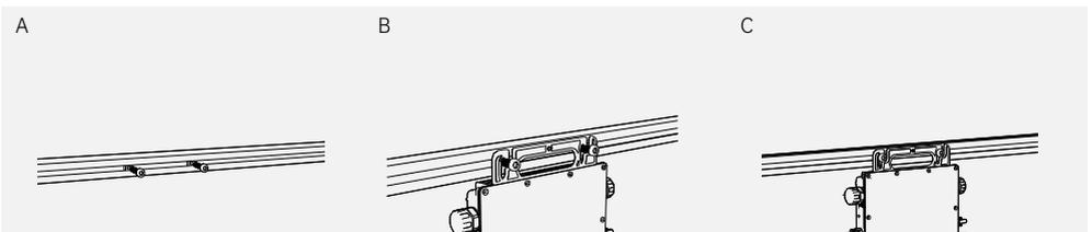
\*Unten montiert und vor direktem Sonnenlicht, Regen, Schnee, UV-Strahlen usw. geschützt. Für spezielle Bereiche bieten wir Erdungshalterungen an. Die Erdungsanforderungen werden erfüllt, indem das Erdungskabel durch die Erdungshalterung geführt und an eine Elektrode angeschlossen wird, die den örtlichen Vorschriften entspricht.
